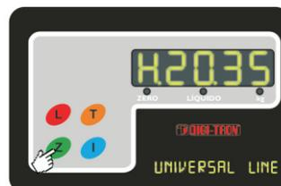
O relógio é alimentado por uma bateria de lítio de longa duração quando a balança se encontra desligada. Um erro é exibido quando a vida útil desta bateria acaba, sendo necessário proceder com ajuste de horário e troca de bateria ( ver **ERRO 7**).
