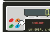
Para aceitar o valor configurado e pular para o próximo passo, pressionar Z.
