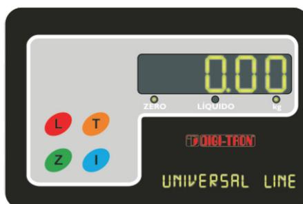
O indicador Tara ( líquido ) fica aceso, indicando que a balança opera no modo Tara.
