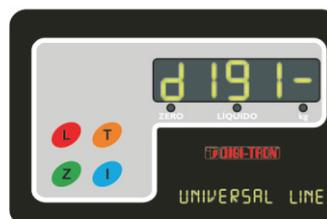
Se acende normalmente mas não consegue terminar a inicialização, a tensão de alimentação é insuficiente. Checar tensão da bateria e recarregar se necessário.
